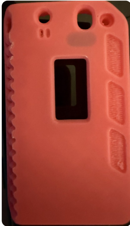
Der Prototyp: Gehäuse aus dem 3D-Drucker, darin ein Heltec V4.
